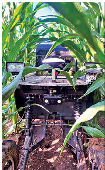
Aujourd'hui, le rover est capable d'épandre les trichogrammes en autonomie, à raison d'environ 3,5 ha/h.
